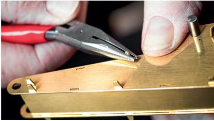
Die Teile werden mittels Laschen zusammengesteckt, diese umgebogen...
